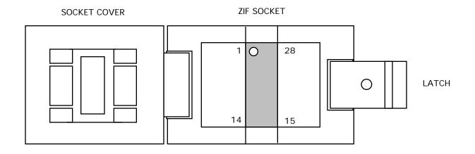
MC68HC705X4DW SOIC DEVICE INSTALLATION
