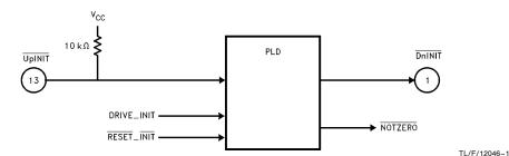
$\overline{\text{DnINIT}} = \overline{\text{IRESET\_INIT & (DRIVE\_INIT + }\overline{\text{UpINIT});}$ NOTZERO = !RESET\_INIT & (!DRIVE\_INIT & UpINIT + NOTZERO);
